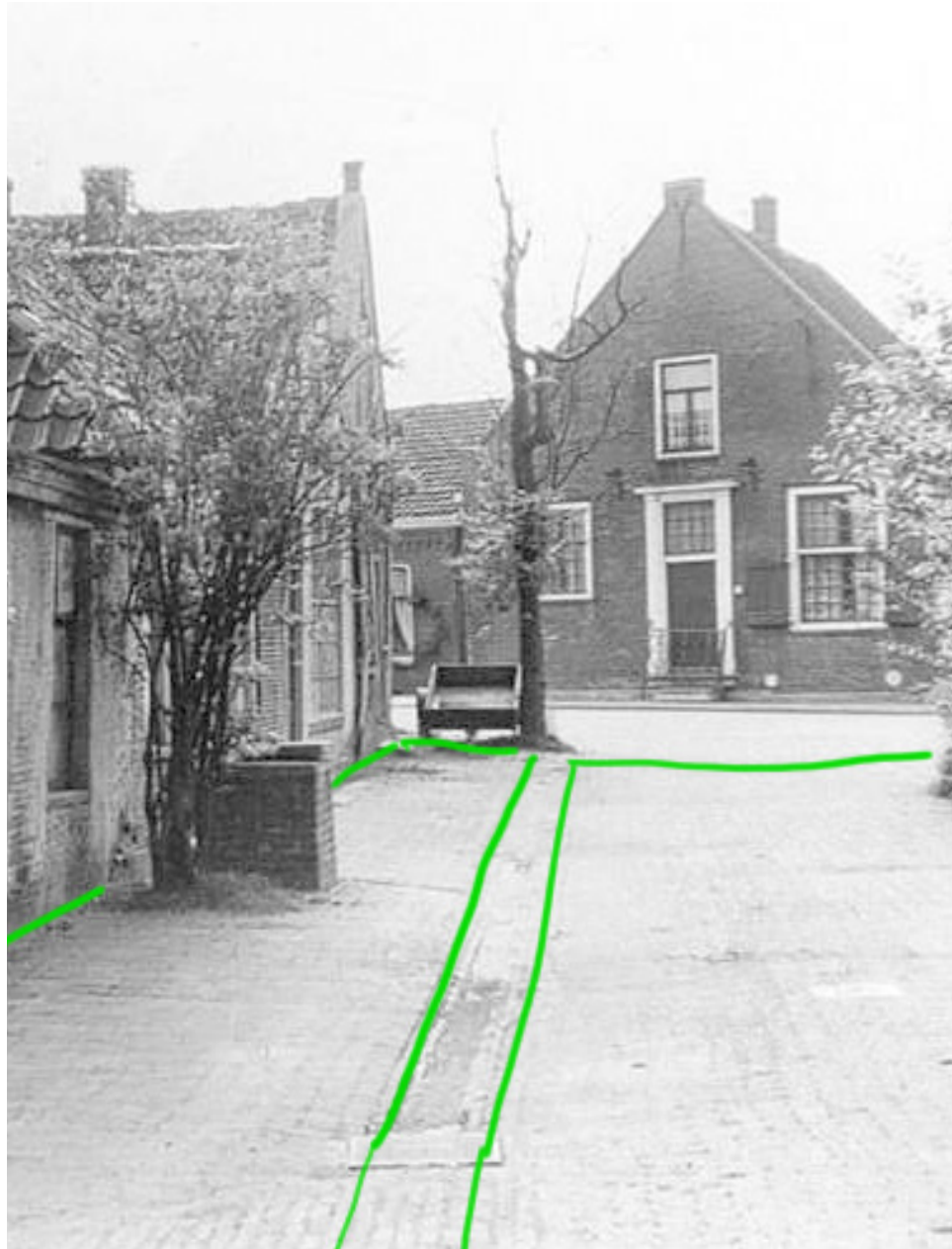
Een simpel profiel met een molgoot als scheiding tussen de rijbaan en het trottoir.
