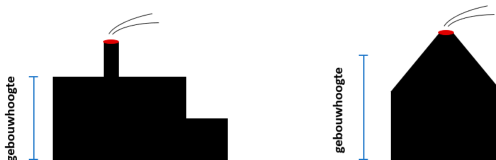
Figuur 4.7 Zijaanzichten van a) gebouw met hoger deel dat hier genegeerd kan worden (links) en b) een (stal)gebouw waarvoor de gemiddelde hoogte wordt genomen (rechts).
